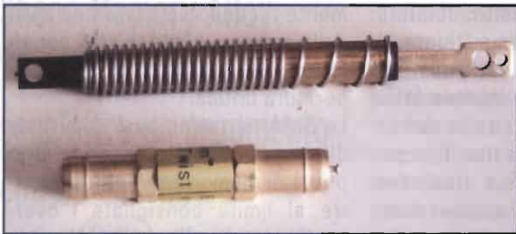
figura 5 Due dispositivi commerciali basati su SMA: un attuttore lineare capace di sollevare fino a 200 grammi (in alto) e una valvola miniaturizzata per fluidi (in basso).
