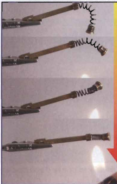
figura 1 sequenza fotografica (dall'alto) di una molla a memoria di forma che, riscaldata alla fiamma di un accendino, riprende la forma iniziale
