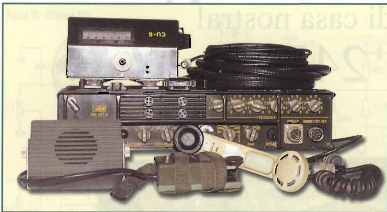
foto 2 Iret VRC 247/A con accordatore, cavi, altoparlante LS2, tasto CW TS1, cornetta MT7-D-MS
